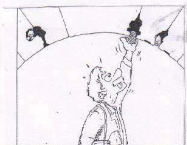
4. La condamnation par un matériau solide (carton fort, tasseaux) des disjointements non occupés évite l'installation future de chauves-souris jusqu'à la réfection des joints.
