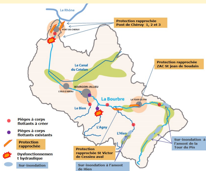
Carte des ouvrages installés pour lutter contre les inondations (source : EPAGE)
